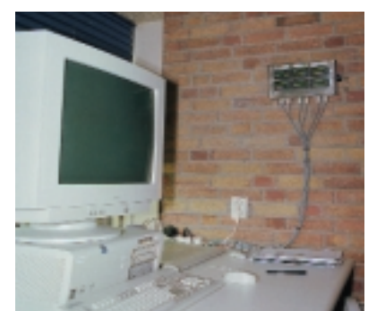
Telunit voor drie CEM 432 breeklijnen met drie twin-laders type CAL 216/2
